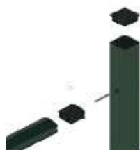
Łączenie słupa końcowego
